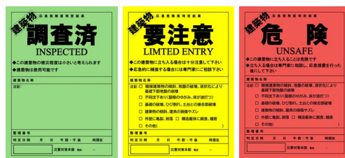
判定ステッカーの例 （建築物判定ステッカー）
