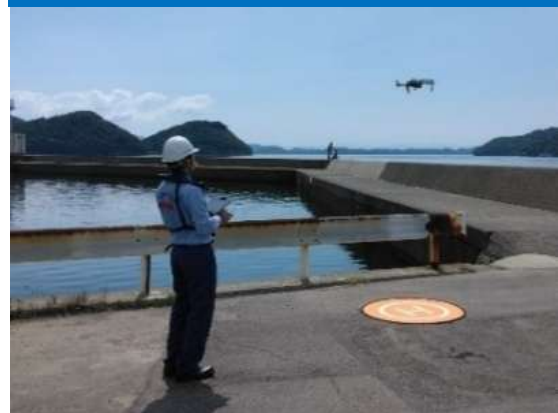
■ドローンによる被災状況調査
