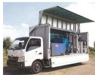
自走式車載型セラミック膜ろ過装置
