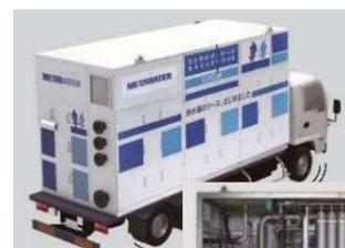
コンテナ収納型セラミック膜ろ過装置
