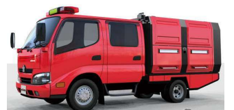
小型動力ポンプ積載車（3.5t未満）
