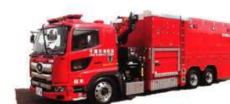
【海水利用型消防水利システム（スーパーポンパー）】
