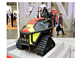
【無人走行放水ロボット】
