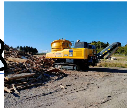
珠洲市ジャンボリー跡地仮置場：移動式破砕機（稼働中）
