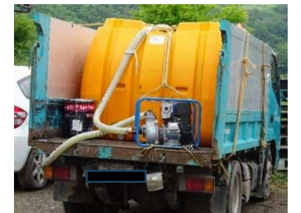
＜水タンク・発電機による給水＞
