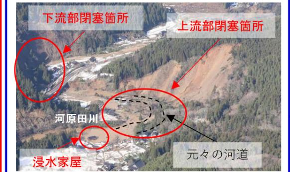
1月11日に河道閉塞箇所の工事に着手し迂回水路掘削を開始
