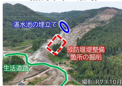
河原田川 恒久対策の施工（輪島市市ノ瀬町）
