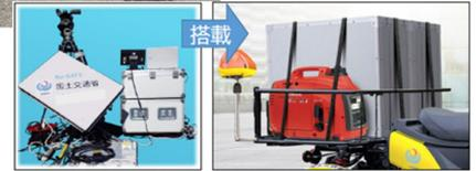
※Ku-SAT(国土交通省専用衛星小型画像伝送装置)
