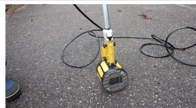
▲管内調査用の管口カメラ
