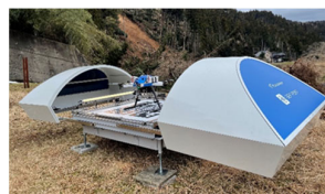
▲ドローンポートシステムを活用した土砂ダム監視活動
