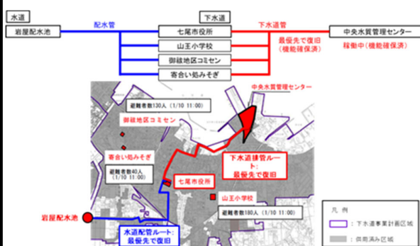
▲上下水道一体となった早期復旧の取り組み
