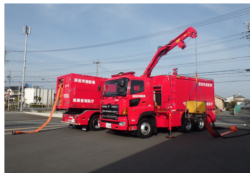
海水利用型消防水利システム
