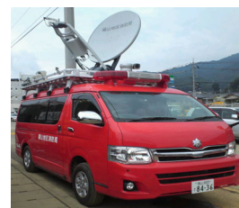
▲緊急消防援助隊に 配備している無線中継車
