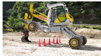
4脚4輪走行式油圧ショベル 通称：スパイダー
