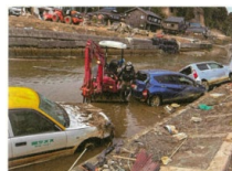
4脚4輪走行式油圧ショベル 通称：スパイダー
