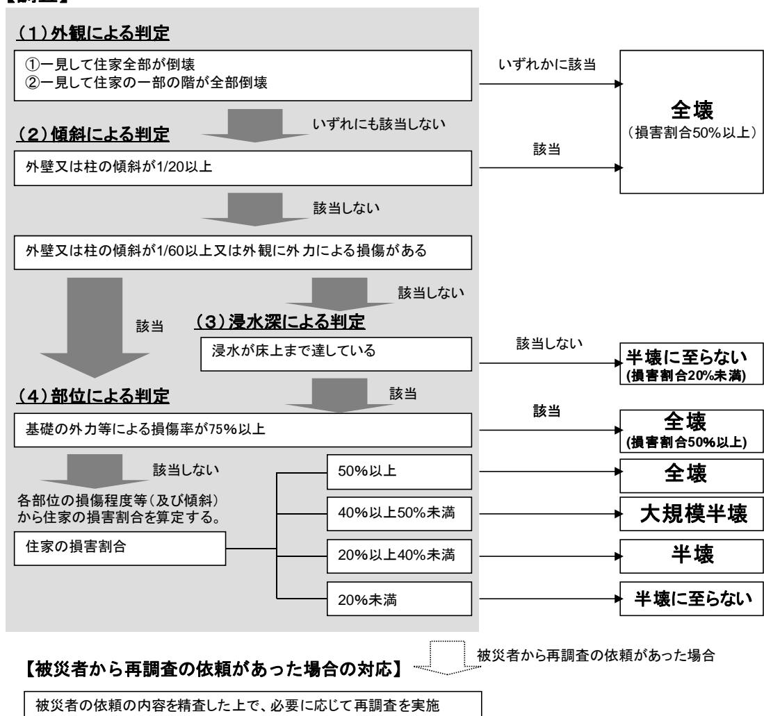
**【第1次調査】**戸建ての1～2階建てで、津波、越流、堤防決壊等水流や泥流、瓦礫等の衝突の外力による損傷がある場合
