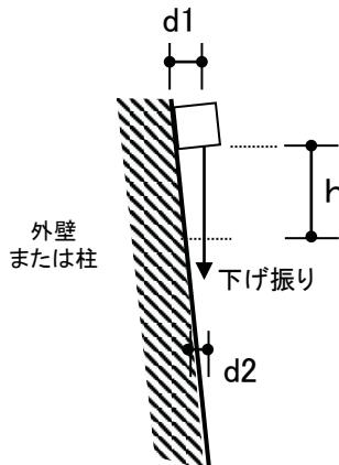
傾斜は、下げ振りの垂直長さ( $h$ )に対して、水平寸法( $d=d_1-d_2$ )の占める割合を計算して測定する。
