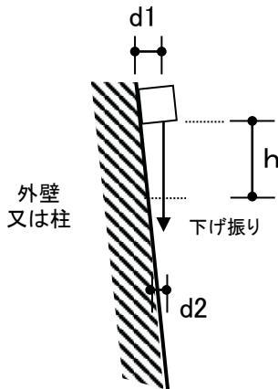
傾斜は、下げ振りの垂直長さ( $h$ )に対して、水平寸法( $d=d_1-d_2$ )の占める割合を計算して測定する。
