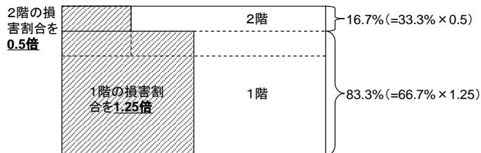
※ (i) ~ (iii) のいずれも斜線部分の割合が、それぞれの方法により算定された住家の損害割合を表す。
