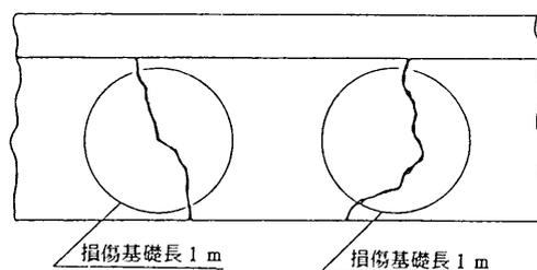
図版出典：「震災建築物等の被災度判定基準および復旧技術指針(木造編)」(財)日本建築防災協会
