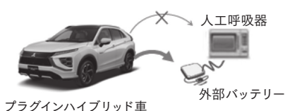
【人工呼吸器の外部バッテリーへの給電】
