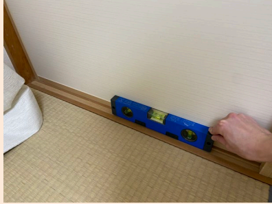
水平器による計測イメージ
