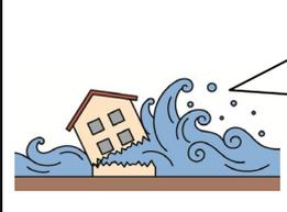
堤防高の大きな堤防整備済み区間における 堤防決壊や越流による氾濫流は流れの勢いが非常に強いため、木造家屋は倒壊するおそれがある
