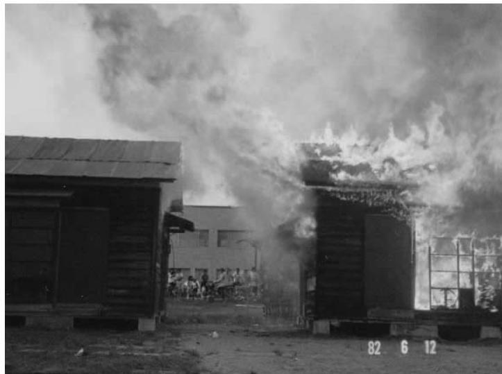
写真5-7 粗略木造（焼き屋）の実大火災実験例（3分40秒、市民防災研究所+泉市消防本部）
