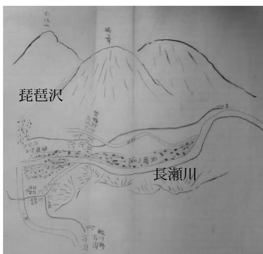
写真 4-12 上山下堰の予算追加の上申文書（明治 21 年 7 月 26 日）及び添付図（福島県歴史資料館所蔵。松井撮影）（添付図に堰が朱色で記入され、琵琶沢並びに長瀬川上流からの土石が堆積している模様が示されている）
