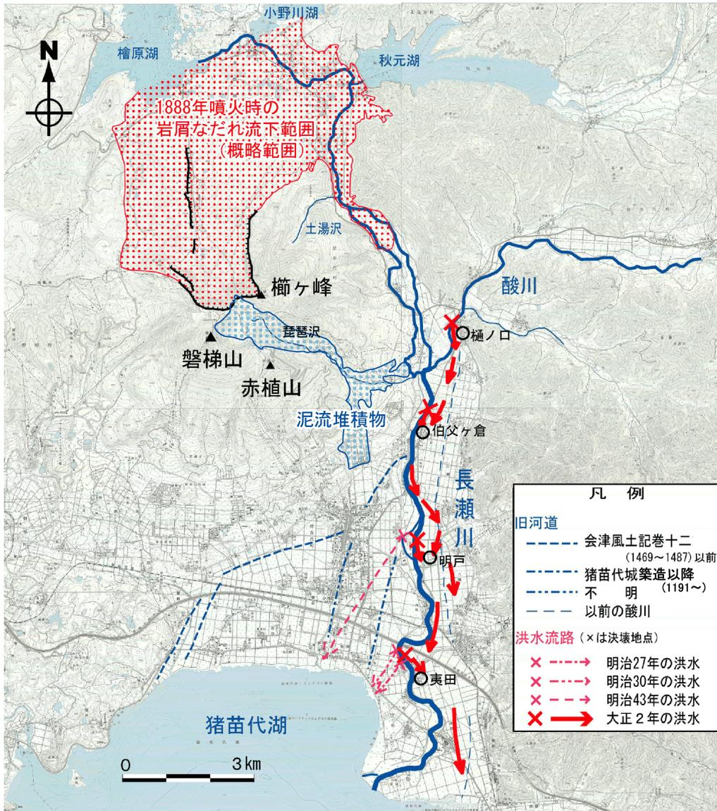
図1 洪水履歴と河道変遷図(貞方, 1979に加筆) (本文 P.99 図4-2)
