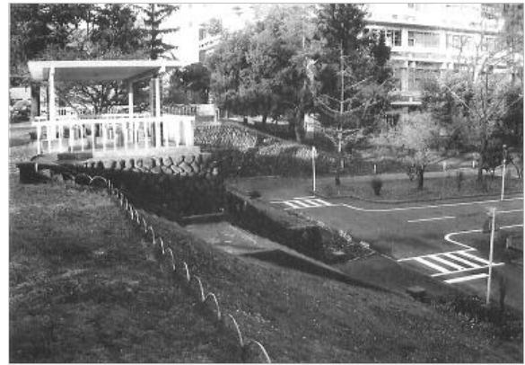
写真 2-1 善光寺地震の地震断層による左右での地面の段差(西長野ひまわり公園) (赤羽貞幸撮影)
