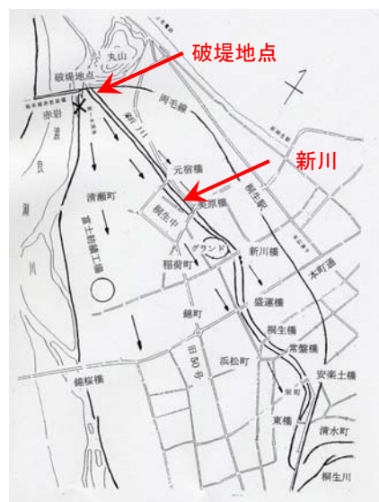
図 1-2 渡良瀬川の破堤による氾濫水の流れ
