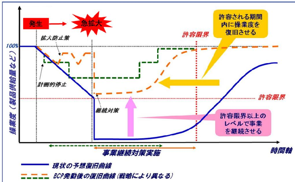
図 1.1-1-2 事業継続計画（BCP）の概念。段階的かつ長期間にわたり被害が継続するリスクの場合<sup>9</sup>
