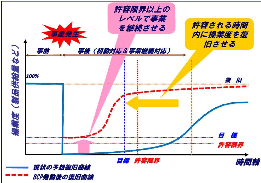
図 1.1-1-1 事業継続計画（BCP）の概念。突発的に被害が発生するリスクの場合<sup>8</sup>
