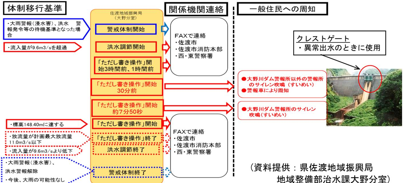
大野川ダムは、通常はダムへの流入量と同程度の水量を放流して常時満水位（標高 142.50m、37 万 $\text{m}^3$ ）を維持しています。
