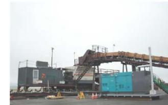
Máquina trituradora y seleccionadora para tratamiento de residuos mezclados
