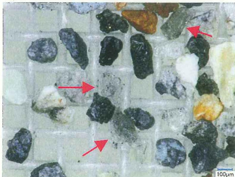
図1 8月3日噴出物の構成粒子。大部分は変質作用をうけた岩片から構成されるが、少量の新鮮なガラス光沢をもつ粒子がみられる(赤矢印)。
