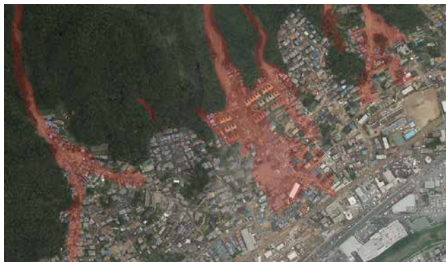
平成26年8月豪雨による広島市八木地区の被害状況。赤く塗られた部分は土砂流出範囲（地理院地図）
