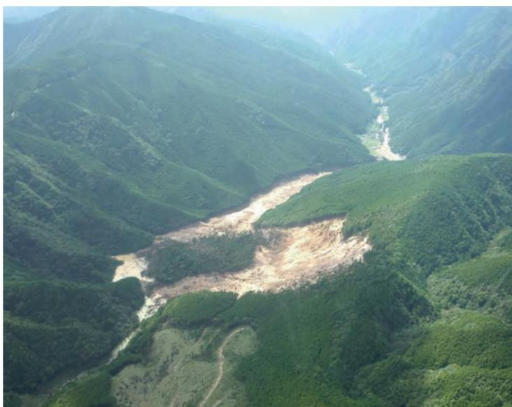
台風 12 号によって崩れた土砂が川を堰き止めてできた河道閉塞（和歌山県田辺市熊野）
