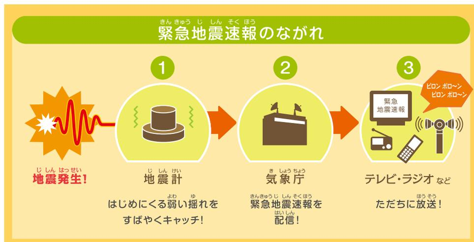
地震の発生直後に、震源に近い地震計でとらえた観測データを解析して震源や地震の規模（マグニチュード）を直ちに推定。最大震度5弱以上と予想された地震の場合に、強い揺れが予想されていることを知らせる（資料提供 気象庁）
