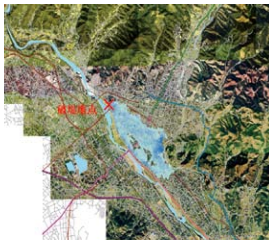
コンピュータシミュレーションによる渡良瀬川左岸破 堤地点からの氾濫流の様子(破堤後30分) 桐生市内を貫流する渡良瀬川の氾濫水は、渡良瀬川同 様に急勾配な扇状地地形に支配されて流下し、その流 速は速く市内を襲う (1947 カスリーン台風報告書、中央防災会議「災害教訓の継承 に関する専門調査会」)
