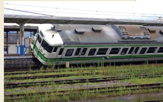
中越沖地震によりJR柏崎駅で倒れた電車（撮影：吉嶺充俊）
