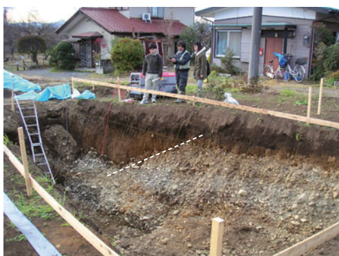
東京都立川市・青梅市などを通る立川断層のトレンチ調査。砂利の層のずれが分かる（写真提供：島崎邦彦）
