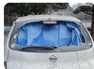
噴石によるリアウィンドウ破損 (気象庁提供)
