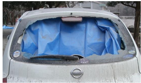
霧島山：小さな噴石によって破損した車のリアガラス 〔出典：気象庁ホームページ〕
