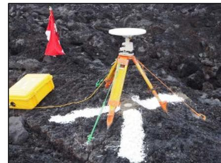
三角点設置後のGNSS測量
