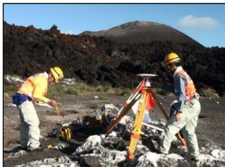
三角点設置後のGNSS測量
