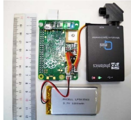
無人機搭載用放出率測定装置の小型・軽量化を実現 900 g⇒130 g (ケース除く)
