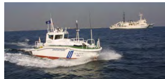
無人測量船「じんべい」 海底火山活動が活発になった時、変色水、精密な海底地形、水温などの観測を無人で行うことが可能。
