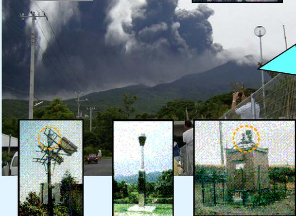
空振計 GNSS観測装置 遠望カメラ
