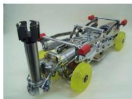
図 4-6 更生工法で使用する削孔機の例
