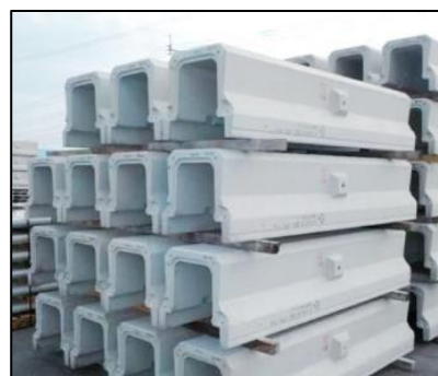
火山灰を細骨材としたコンクリート製品（鹿児島県）
