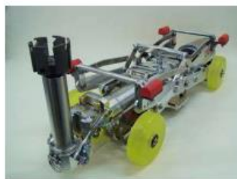
図 4-6 更生工法で使用する削孔機の例
