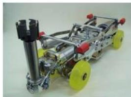
図 4-6 更生工法で使用される削孔機の例
