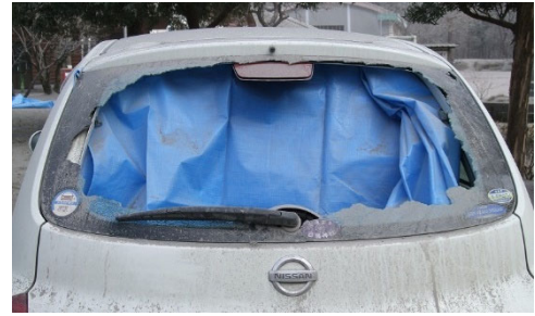
霧島山：小さな噴石によって破損した車のリアガラス 〔出典：気象庁ホームページ〕
