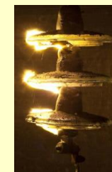
火山灰を用いた 碍子の 閃絡実験
