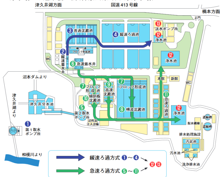
浄水場のろ過系統の例(神奈川県 谷ヶ原浄水場)
