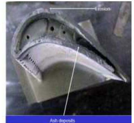
タービンブレードの冷却による火山灰の影響 (左) 模式図、(右) 付着事例 (安田・他, 2011)
