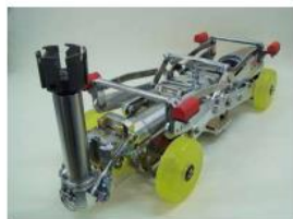
図 4-6 更生工法で使用される削孔機の例
