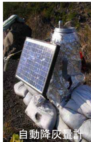
●自動降灰量計による降灰量の推移(2009年4~12月)
